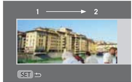
En primer lugar, hay que poner la cámara en el modo Stitch Assist (Asistencia para montaje). Entre otras características, esto permite indicar a la cámara si el usuario la está moviendo a la izquierda o a la derecha (o arriba o abajo) a medida que se dispara la secuencia de fotogramas.
